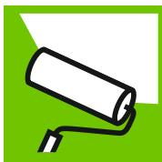
Stěrkovou hmotu lze na podklad nanášet malířským válečkem s delším vlasem. Doporučená délka vlasu je cca 18 mm. Nanesený materiál se vyhladí nerezovým hladítkem nebo špachtlí.
